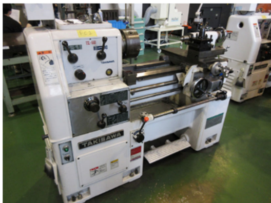
図-3 株式会社滝澤鉄工所 小型普通精密旋盤 TSL-550
