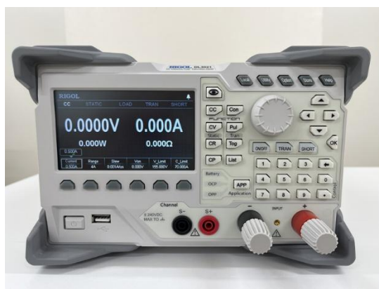
図 6 電子負荷制御装置
