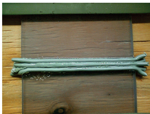
図-3 溶接終了時の状態
