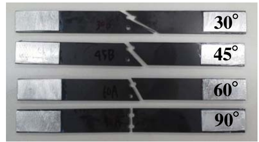
図-3 30°から90°の破断状態
