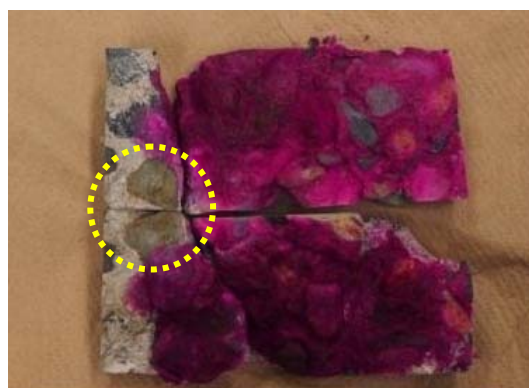
写真-13 コア割裂断面のフェノールフタレイン呈色反応
