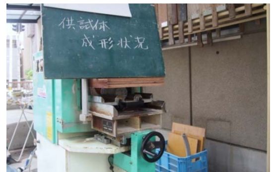
写真-6 コア端面の成形
