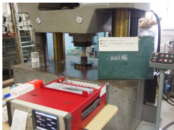
写真－7 圧縮強度試験とひずみの測定
