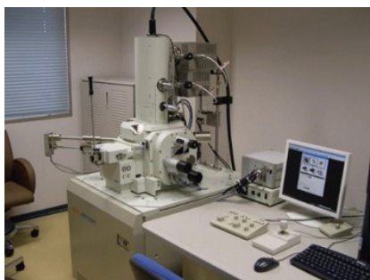
写真-3 微小領域XRD（左），FE-SEM+EBSD（右）
