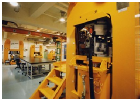
写真-2 6000トン駆動（左），1000，2000，3000トン駆動（右）マルチアンビル装置
