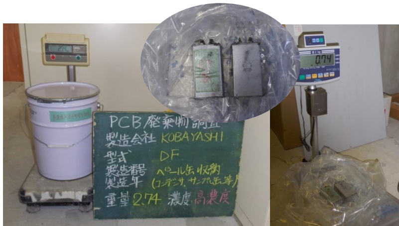
写真 4 分析によって高濃度 PCB 含有が明らかになったコンデンサ
