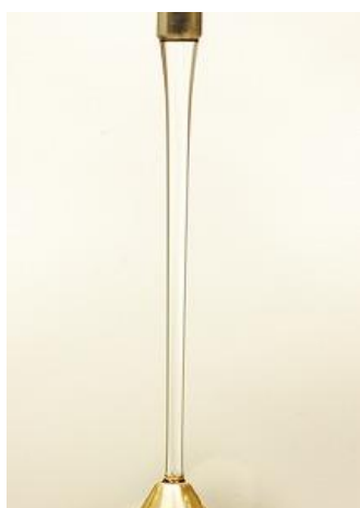
図-2 PAA のスピンドル画像 ( PAA, 0.1 wt %, Q = 1.4 \text{ ml/min} )
