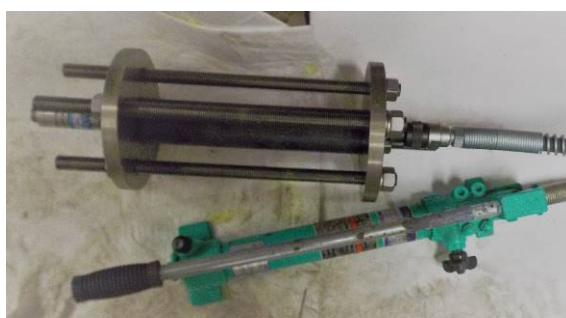
図-4 耐圧実験装置1号機外観
