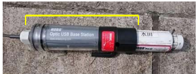
写真-4 温湿度計データ読み取り機
