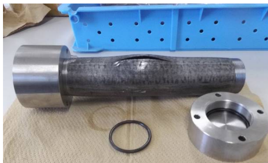
図-6 耐圧実験装置3号機外観
