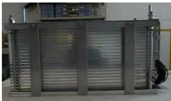
写真-1 せん断土槽全景
