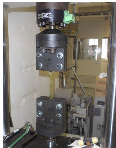
図－3 一軸引張試験
