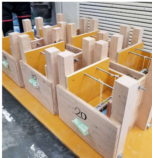
写真-2 コンクリート供試体型枠
