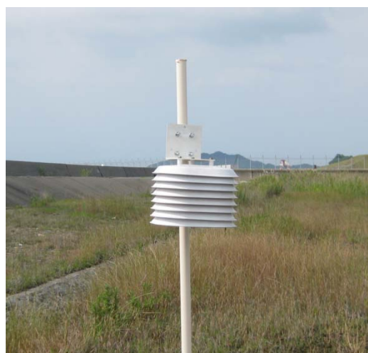
写真－3 設置状況（自然通風式シェルター） (Onset社のソーラーラジエーションシールド RS1)
