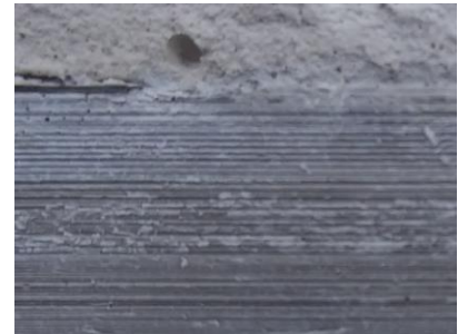
図-6 石膏型内壁の積層跡
