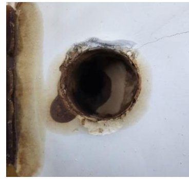
図-5 加熱後の石膏型の様子
