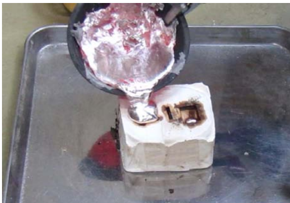
図-7 石膏型へのアルミ湯の注入
