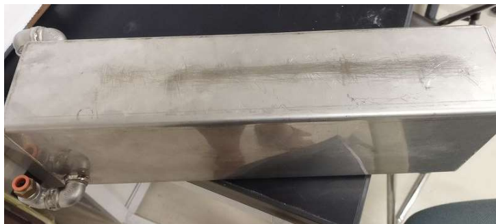
図2 変形による空圧タンクのすり傷
