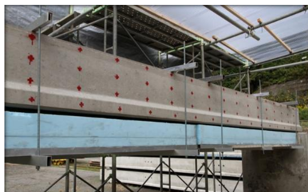
写真2 塩害と電食による鉄筋腐食実験
